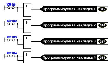
Рисунок 16.2 – Конфигурирование дискретных входов
